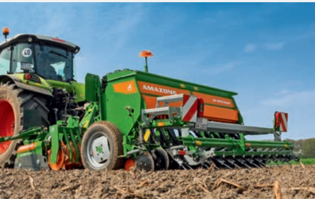
D9 3000 Super ar nolīdzināšanas ecēšām kombinācijā ar rotējošajām ecēšām un zobratu veltni
