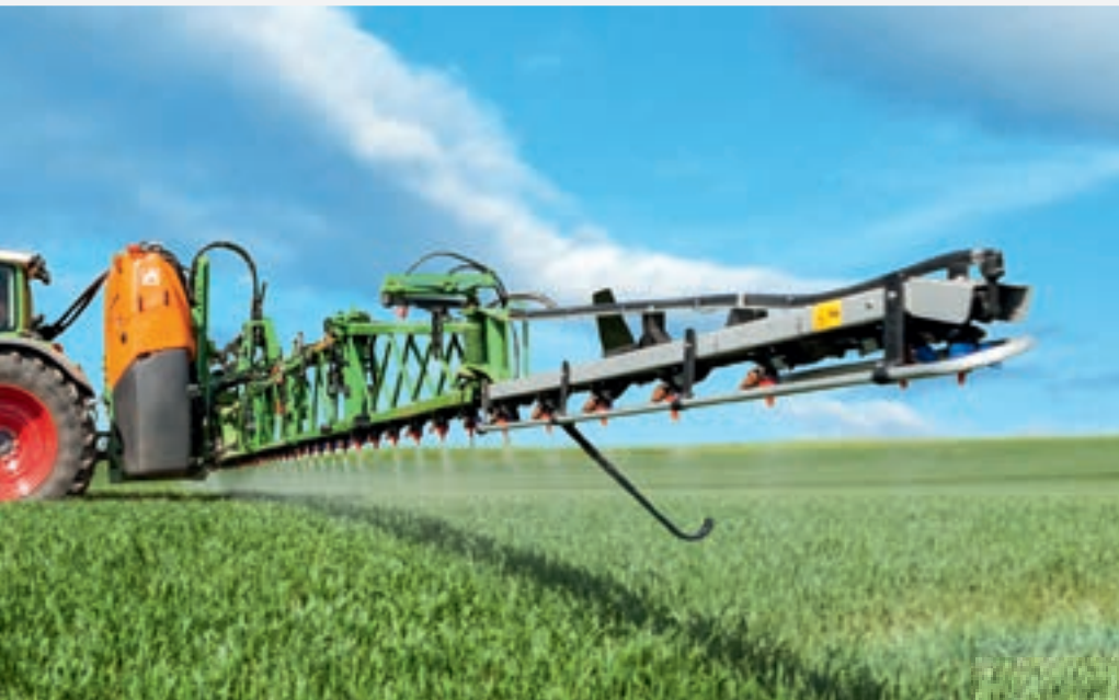
Uzkarināmie miglotāji UF 2002 ar 30 m Super-S2 stangu sistēmu
