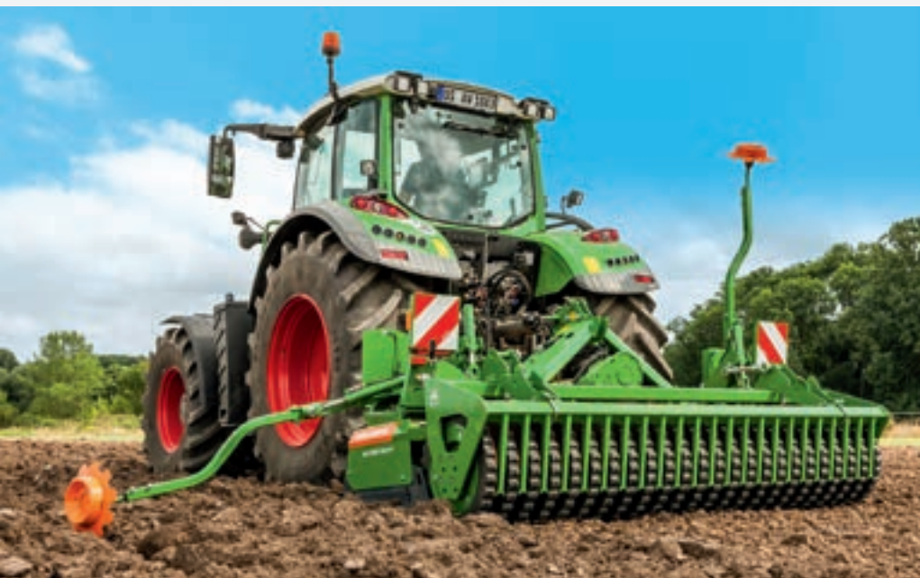
Rotējošais kultivators KG 3001 ar ķīļriņķu veltni ar Matrix riepu profilu
