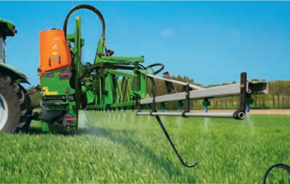
Uzkarināmie miglotāji UF 1201 ar 18 m Super-S2 stangu sistēmu
