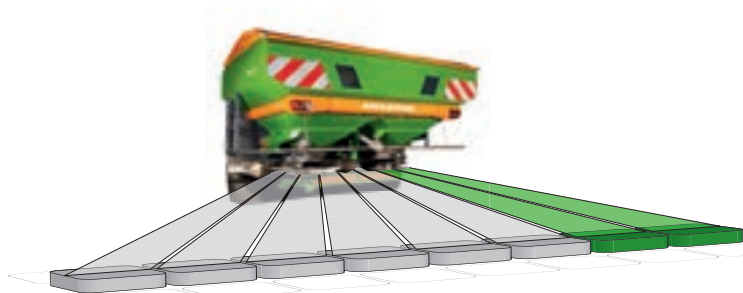
Ar ZA-V samazinātā platuma pārslēgšanu 8 vai 16 pakāpēs iespējams regulēt atsevišķas ārpusē esošās platuma daļas
