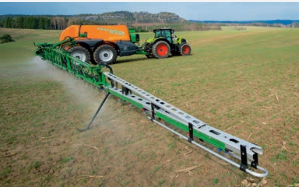
Piekabināmais miglotājs UX 11200 ar 40 m Super-L2 stangu sistēmu
