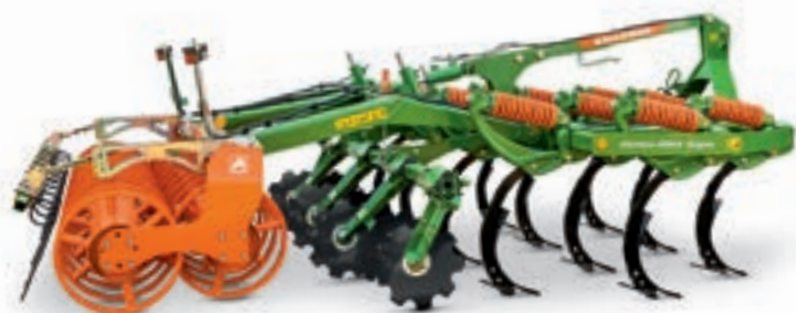
Cenius Super: C-Mix zari ar pārslodzes drošības atsperu sistēmu 600 kg un izcelšanas augstumu 30 cm – ideāli arī ekstrēmās izmantošanas apstākļos.
