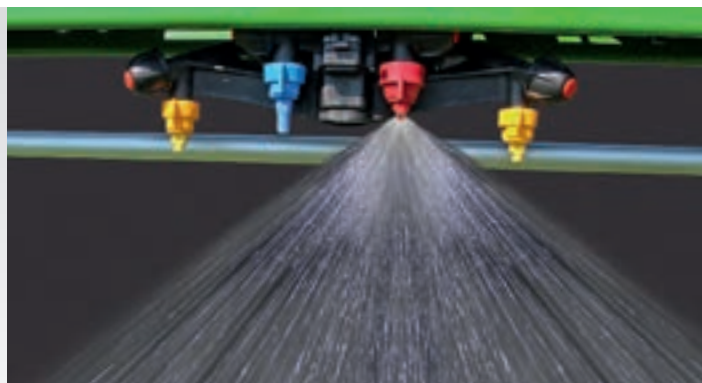
Elektriskā atsevišķo sprauslu pārslēgšana AmaSelect ar četrkāršu sprauslas korpusu un 50 cm vai 25 cm sprauslu attālumu
