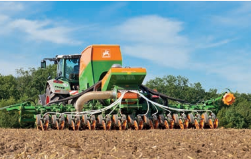
Precīzās izsējas sējmašīna EDX, 6 m darba platumus
