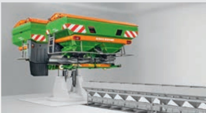
Moderna mēslojuma izkliešanas testēšanas halle
