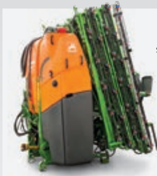
UF 1201 ar 21 m Super-S1 stangu sistēmu
