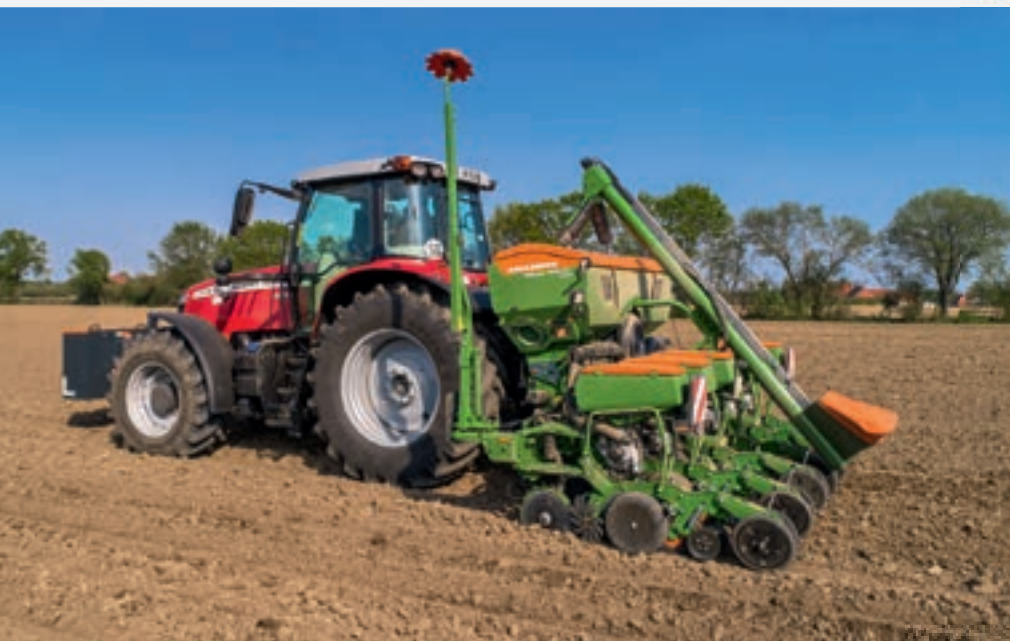
6 rindu precīzās izsējas sējmašīna Precea 4500-2CC
