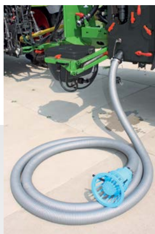
Uzpilde ar vakuuma šļūteni
