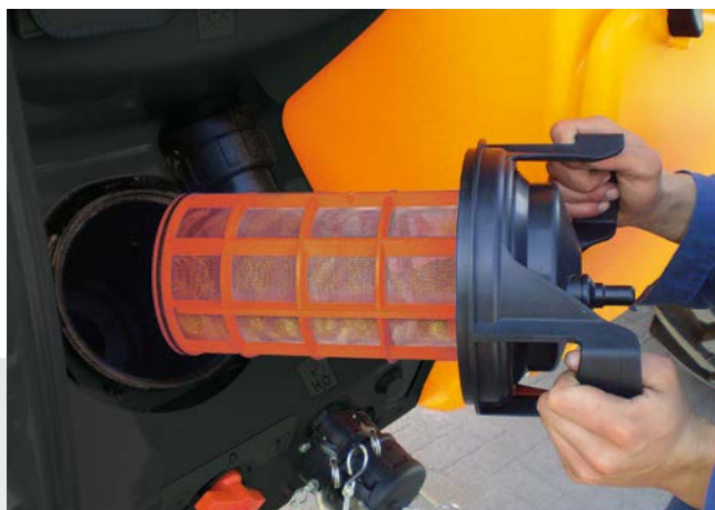
Iesūkšanas filtru var atvērt un iztīrīt pilnai mašīnai bez miglošanas šķidruma zuduma.
