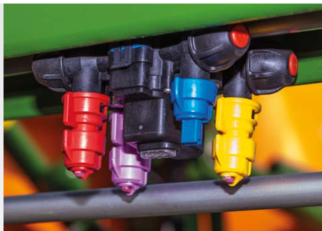
✓ Elektriskā atsevišķo sprauslu pārslēgšana AmaSelect
