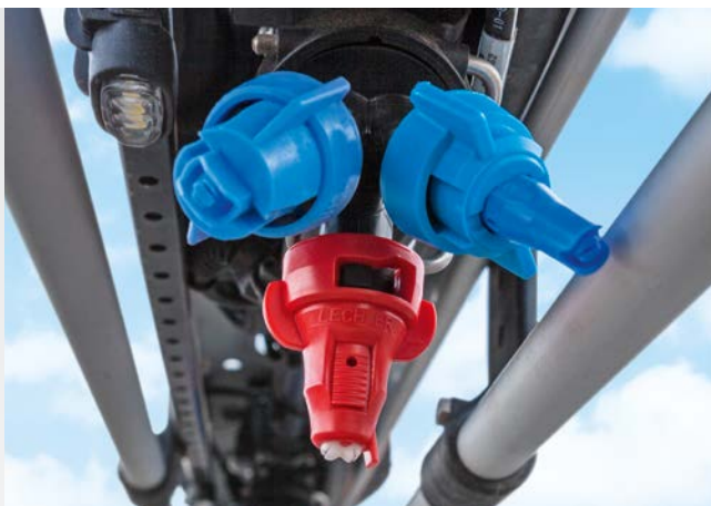
✓ Elektriskā atsevišķo sprauslu pārslēgšana AmaSwitch
