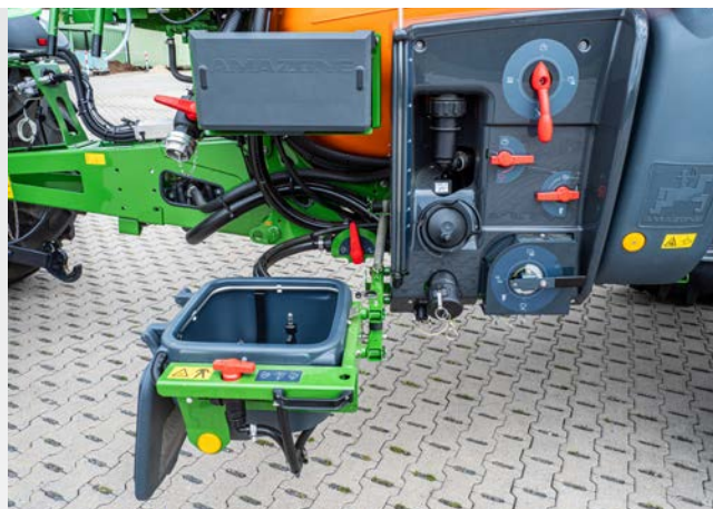
SmartCenter mašīnas kreisajā pusē ar atlocītu ieskalošanas tvertni
