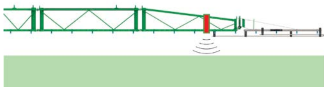
DistanceControl ar aprīkojumu ar diviem sensoriem: Mērījums sējumos
